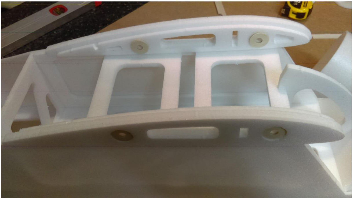
Keine Schraubenköpfe wie auf dem Bild, sondern Magnete 6x6 einsetzen
